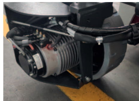
Motore elettrico AC. Sterzo idraulico a 90°
