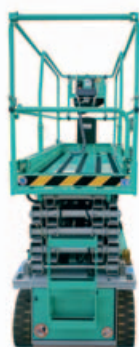
Nuovo design della PLE, della struttura forbice e del cancello di ingresso autobloccante.
